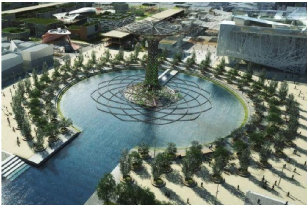
L'albero della vita progettato da Balich è una struttura interattiva alta 35 metri che sorgerà al centro del laghetto. I rami formeranno un ombrello del diametro di 45 metri. La parte interna sarà in acciaio, quella esterna in legno lamellare
